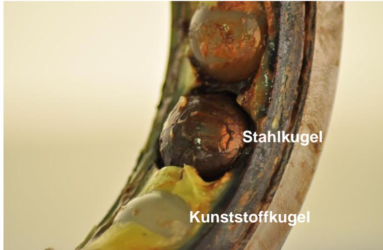
Unteres Prüflager (mit NaCl)
